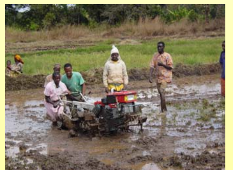
Wakulima wa Skimu ya Nakahuga waki-jifunza kwa vitendo jinsi ya kutumia trekta la mkono kwa kuchavanga
